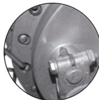
Imagen 24. Indicador de desgaste del freno trasero.
