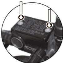
Imagen 27. Completar el nivel del líquido de freno.
