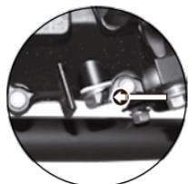
Imagen 17. Ubicación del tornillo de drenado.
