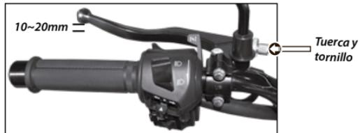
Imagen 21. Ajuste de la palanca del embrague.
