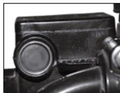
Imagen 26. Nivel del líquido de freno delantero.
