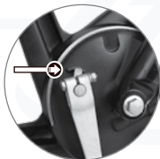
Imagen 21. Indicador de desgaste del freno delantero.
