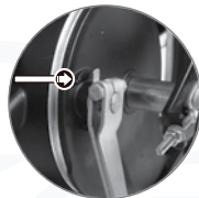
Imagen 22. Indicador de desgaste del freno trasero.
